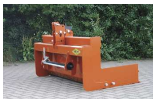
↑ De mechanische Trekkerbak 150 is als enige uitgevoerd met 'vlakke' zijplaten.
