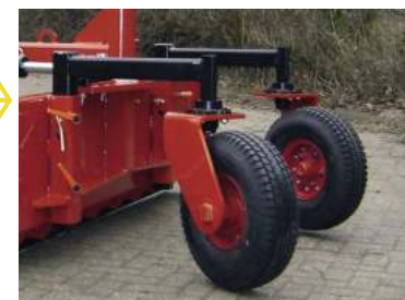
Trekkerschuif uitgevoerd met 2, mechanisch in hoogte stelbare, slingerwielen.
