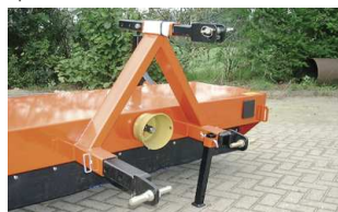
↑ Zwenkwielen (luchtbanden) in hoogte verstelbaar d.m.v. draadspindel
