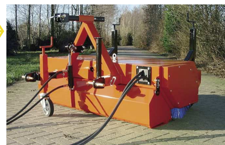
→ HVM-165 met hydraulisch bediende opvangbak en een extra stelbaar steunwiel
