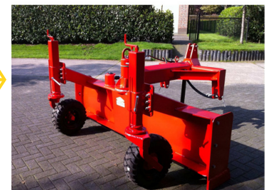
Trekkerschuif uitgevoerd met 2, mechanisch in hoogte stelbare, slingerwielen.
