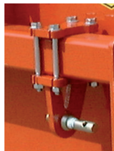
↑ Trekkerbakken, standaard met in breedte verstelbare liftblokken.
